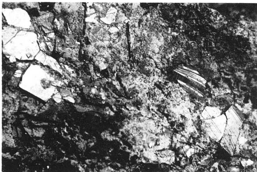
Рис. 2. Пластинчатые кристаллы гематита в трещинах измененного андезита, местонах. Ситнианска Леготка, увел 4,5 х. Фото Л. Освалд.
